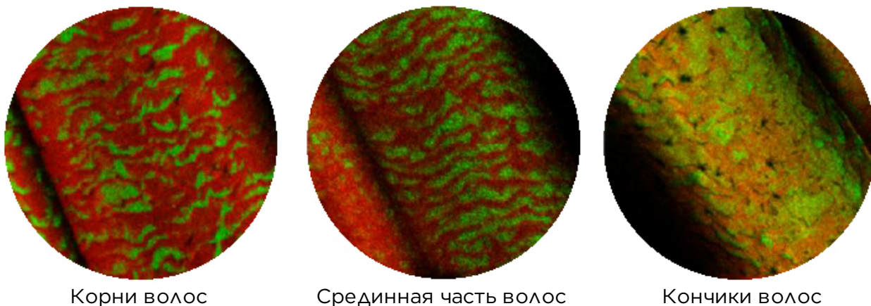
Рисунок 1: ToF-SIMS изображения различных участков волос после обработки FF-W-01 (места локализации FF-W-01 видны как зеленые участки)
